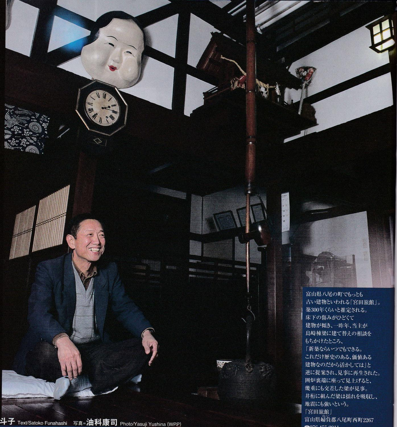
富山県八尾の町でもっとも古い建物といわれる「宮田旅館」。築300年くらいと推定される。床下の傷みがひどくて建物が傾き、一昨年、当主が島崎棟梁に建て替への相談をもちかけたところ、「新築ならいつでもできる。これだけ歴史のある、価値ある建物なのだから活かしては」と逆に提案され、見事に再生された。囲炉裏端に座って見上げると、幾重にも交差した梁が見事。井桁に組んだ梁は揺れを吸収し、地震にも強いという。「宮田旅館」富山県婦負郡八尾町西町2267 ☎076-455-2011
